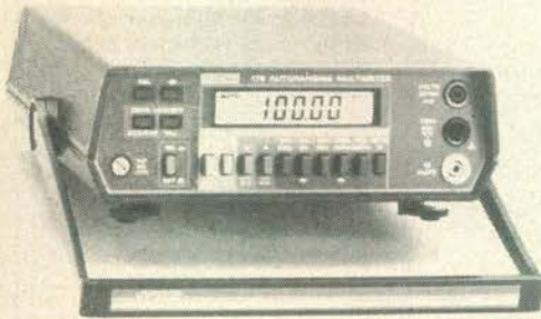
Model 175 : 4½ digit, 10 uV, meetwaarde geheugen met 6 meetsnelheden ( 100 plaatsen ).
